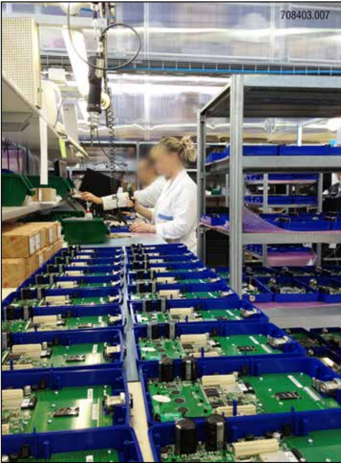
Validatrici contactless Futura 3A in colore personalizzato durante la costruzione. La produzione è al 100% in Italia / Color customized Futura 3A contactless validators during construction. Production is 100% in Italy.
