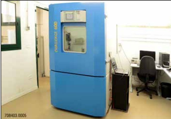
Ogni nuovo apparato è accuratamente collaudato nella camera climatica, anche in condizioni estreme di temperatura e di umidità / Any new device is thoroughly tested in AEP climatic chamber, also in extreme temperature and humidity conditions.
