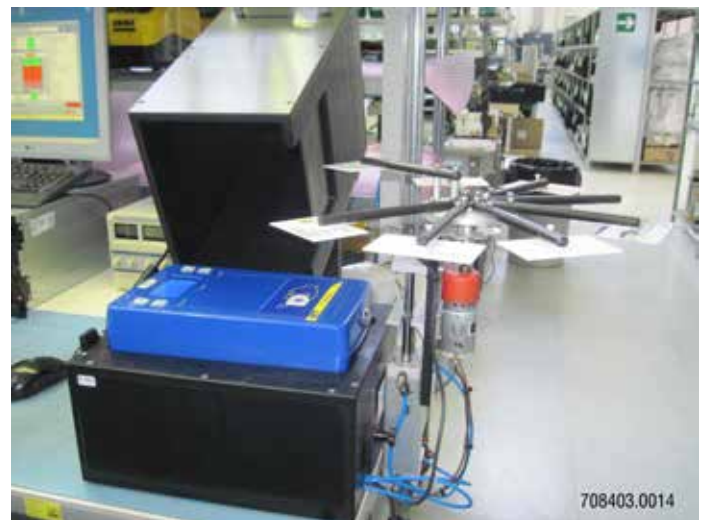
L'ispezione visuale computerizzata e il test funzionale del lettore di smart card. Il 100% della produzione viene collaudato singolarmente. / Display computerized visual inspection and smart card reader functionality test. 100% of production is individually tested.
